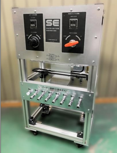
移動式ガス制御架台
